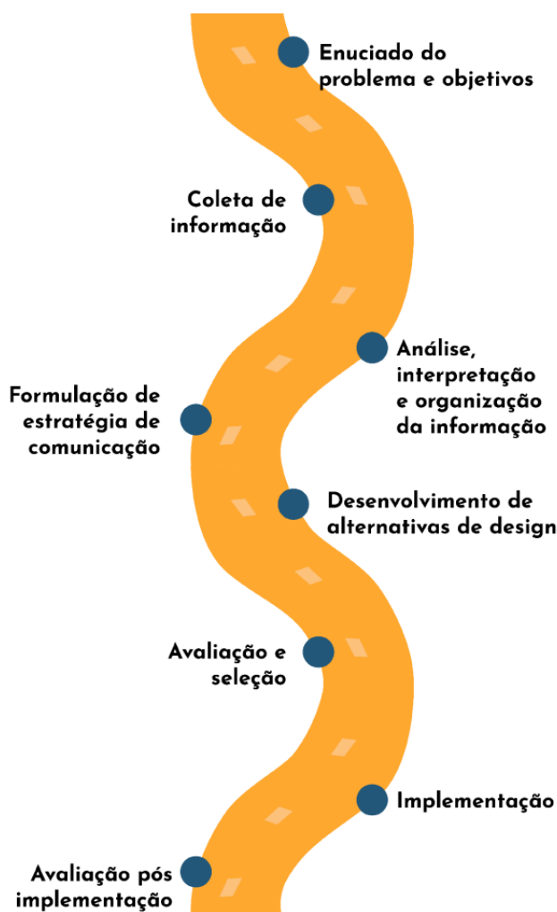
Figura 19: Esquema das etapas de projeto de sinalização de Frascara (2011). (Fonte: a autora, 2025).
