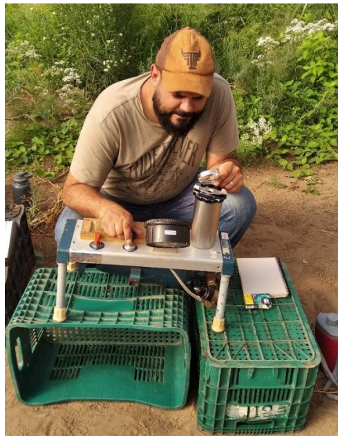
Figura 11 – Uso da câmara de Scholander para estimativa o potencial hídrico foliar.
