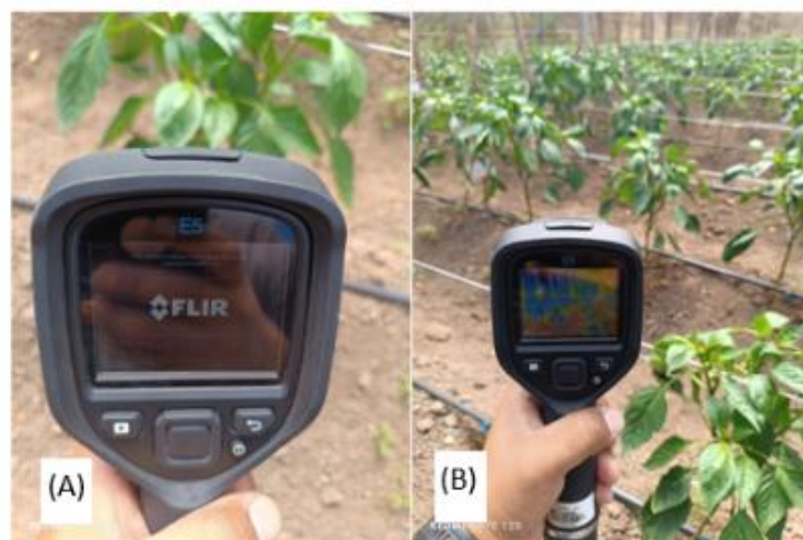
Figura 13 - (A) Câmera termográfica Flir E5xt e (B) representação da imagem térmica no visor da câmera.
