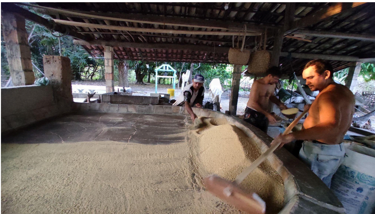
Figura 40 - Farinha já assada é recolhida para a esfriadeira e ensacada.
