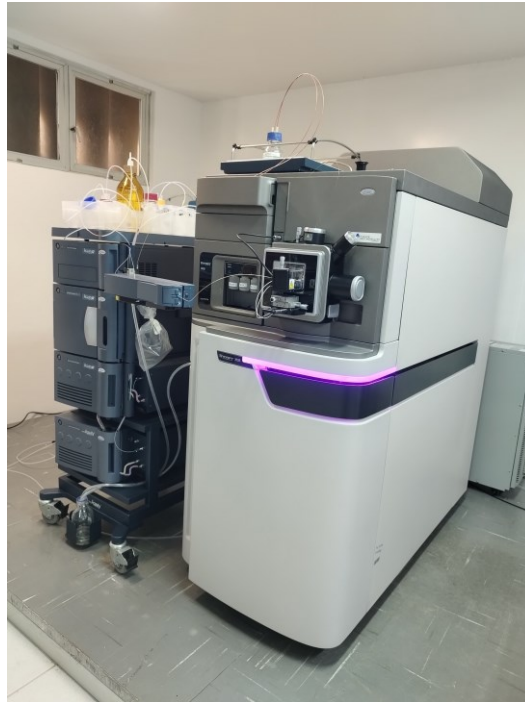
Figura 31 – Espectrômetro de massas LC-MS fabricado pela Waters Corporation.
