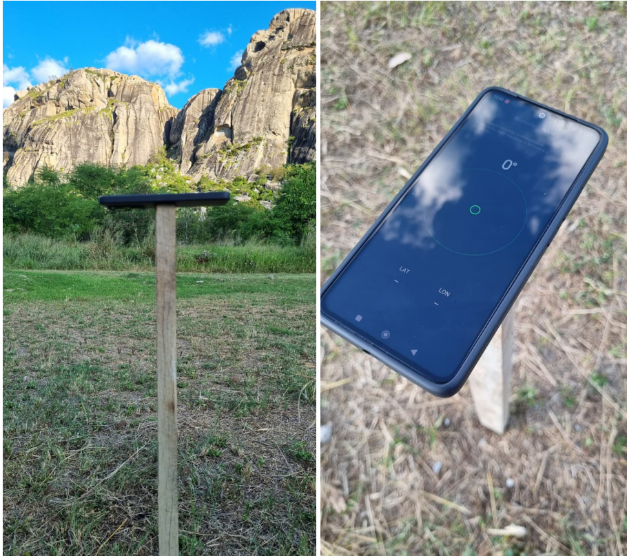
Figura 55 – Critério de instalação: (a) Suporte de madeira e (b) Verificação de nivelamento (0°).
