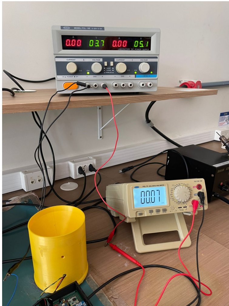
Figura 64 – Medição de corrente em modo Deep Sleep com multímetro digital.
