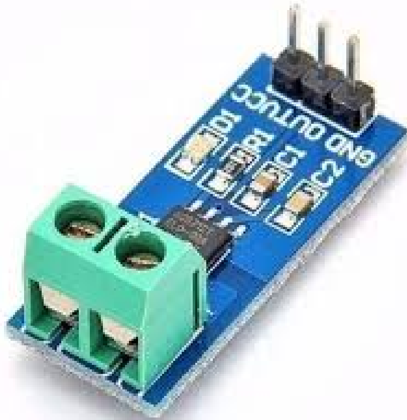
Figura 3 – Módulo sensor de corrente baseado no efeito Hall (ACS712).
