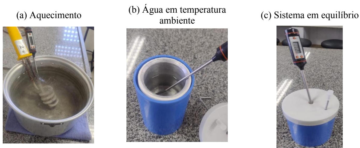
Figura 7 – Procedimento experimental adotado para a determinação do calor específico das amostras de concreto.
