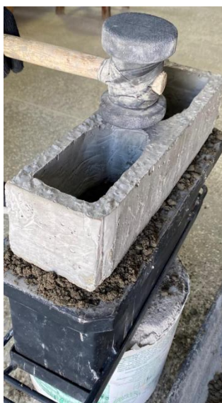
(b) Compactação e acabamento superficial
