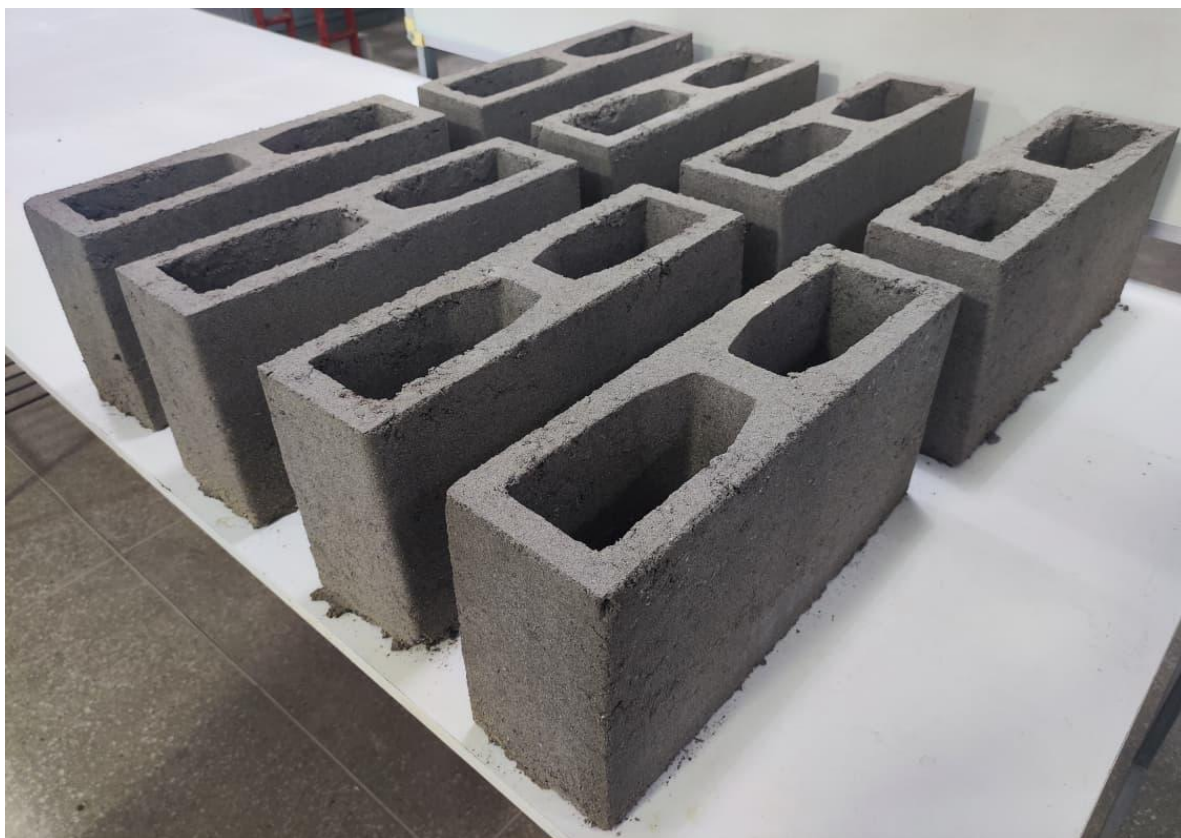
Figura 11 – Blocos de concreto para vedação produzidos em escala real.
