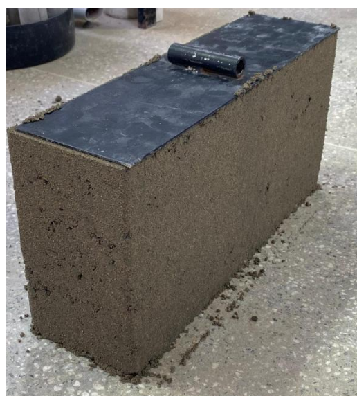
(c) Desmoldagem e cura inicial dos blocos
