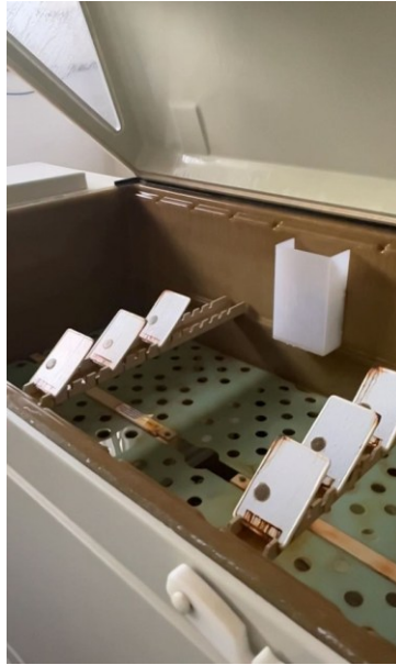
Figura 4 – Amostras durante o ensaio de exposição em câmara de névoa salina
