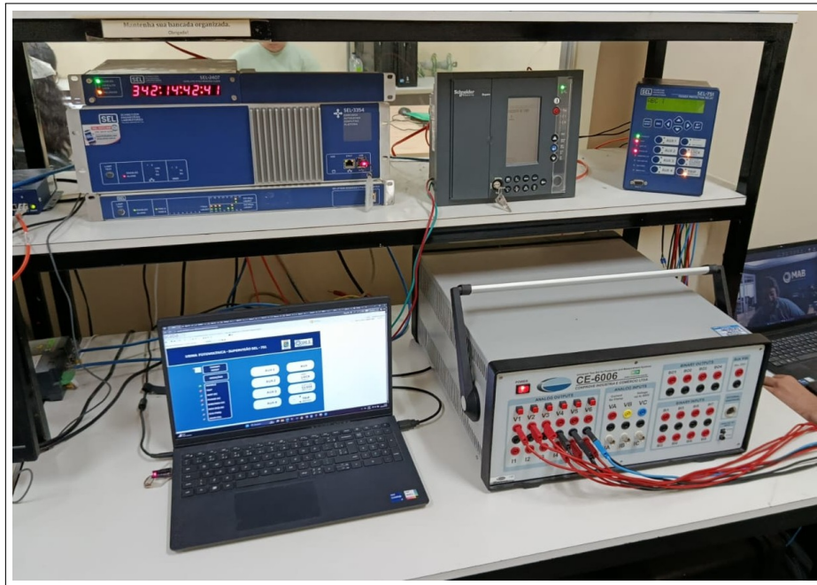
Figura 53 – Bancada de teste função 51
