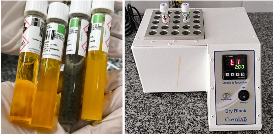
Figura 5 – Testes de DQO: (a) Amostras do Kit Hanna Instrumentos de DQO HI93754B-25 e (b) Amostras aquecidas no bloco digestor
