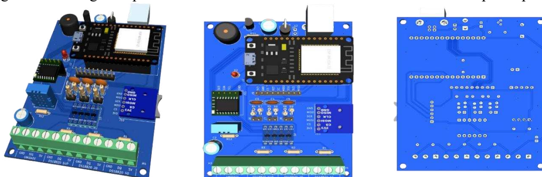
Figura 32 - Design 3D personalizado de PCB utilizada na versão atualizada do protótipo
