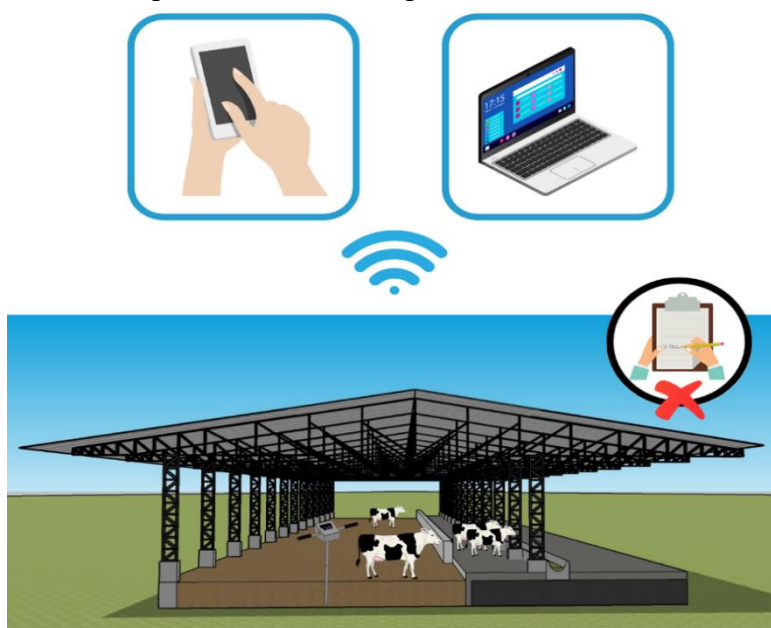
Figura 37 - Esquema dos sensores instalados em cama de compost barn para medir condições térmicas e variáveis ambientais, com envio dos dados via Wi-Fi para plataforma em nuvem para análise em tempo real
