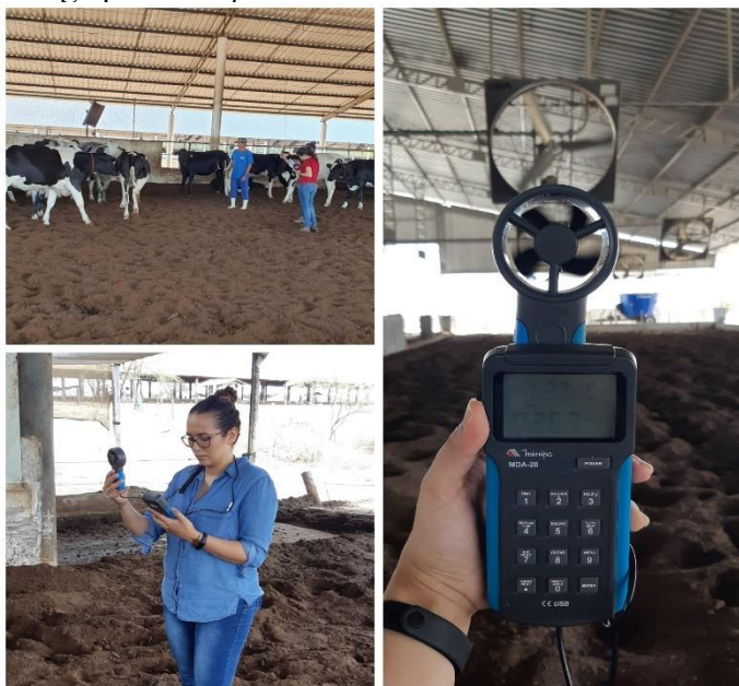
Figura 3 - Mensuração da variável velocidade do ar em galpões compost barn
