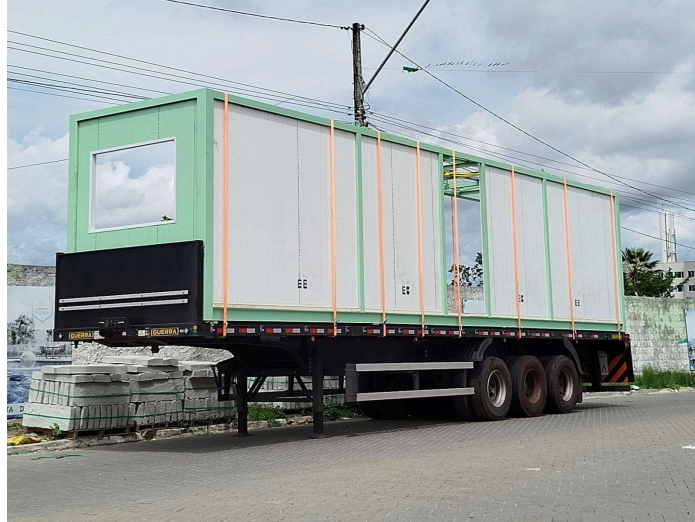
Figura 3 - Transporte de Módulo Habitacional
