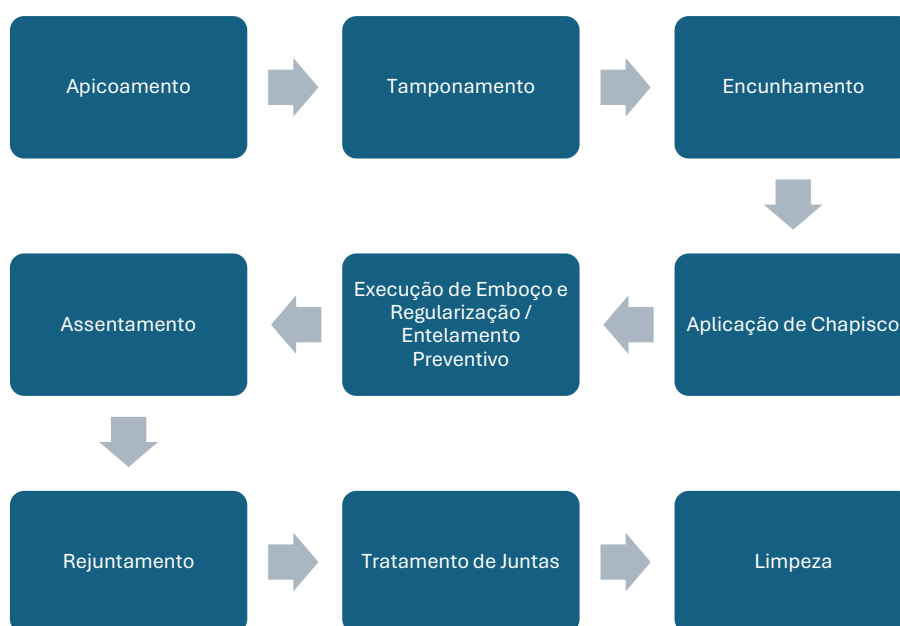
Figura 31 - Fluxograma de execução da Fachada Aderida.
