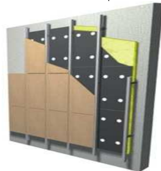
Figura 12 - Isolante Térmico entre o suporte e a fachada ventilada.
