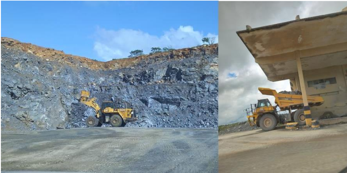
Figura 4 - Carregamento e transporte do calcário da bancada até o britador
