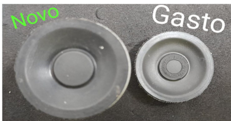
Figura 19: Comparação entre um dos componentes da válvula gasto vs. novo
