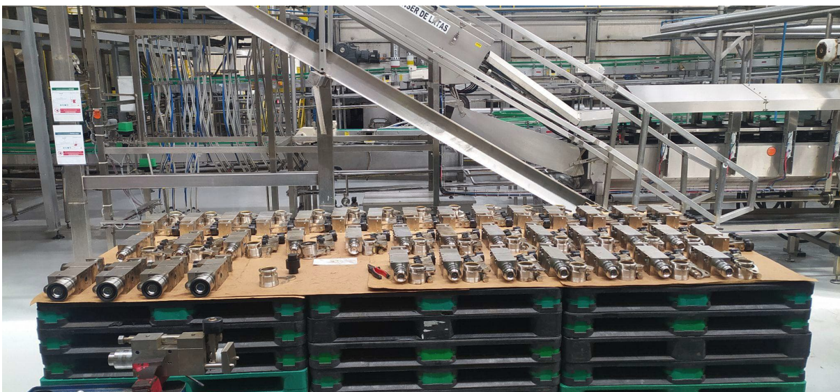
Figura 18: Inspeção das válvulas da Enchedora
