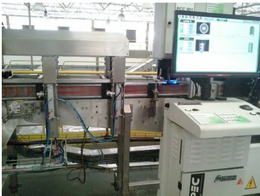
Figura 7: Inspetor de Latas Vazias (Pressco) 2
