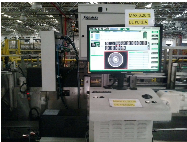
Figura 6: Inspetor de Latas Vazias (Pressco) 1
