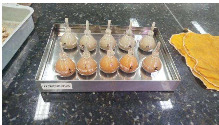
Figura 22 - Picnômetros em banhos de água a temperatura ambiente
