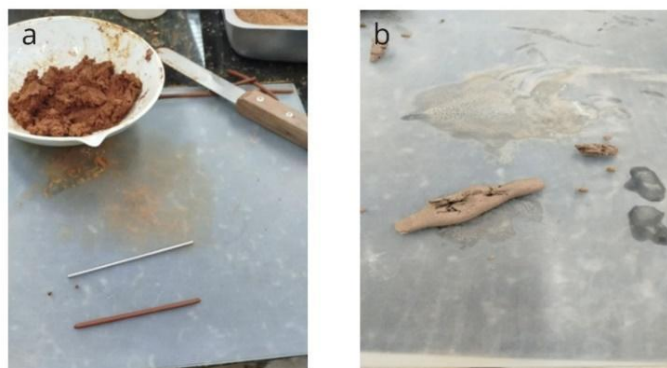
Figura 21 - Realização do ensaio do limite de plasticidade 21a) Solo A; 21b) Solo B.
