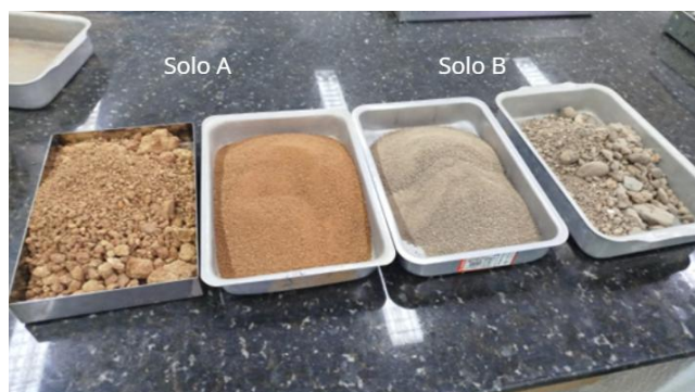
Figura 15 - Material utilizado para ensaios de granulometria da fração grossa, fração fina e sedimentação
