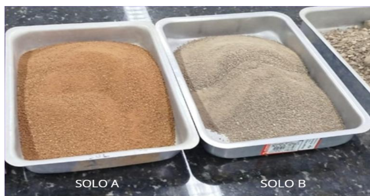
Figura 19 - Solos utilizados nos ensaios de determinação do limite de liquidez e plasticidade
