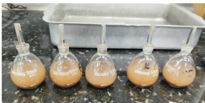
Figura 26 - Densidade real dos solos da mistura
