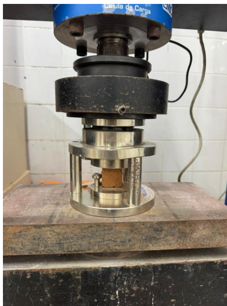
Figura 30: Rompimento do corpo de prova
