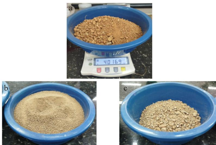
Figura 24 - 24a) Mistura dos dois tipos de solo; 24b) Material usado na granulometria da fração fina; 24c) Material usado na granulometria da fração grossa
