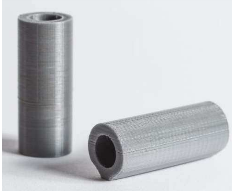
Figura 23 - Efeito da orientação na qualidade superficial e na precisão dimensional
