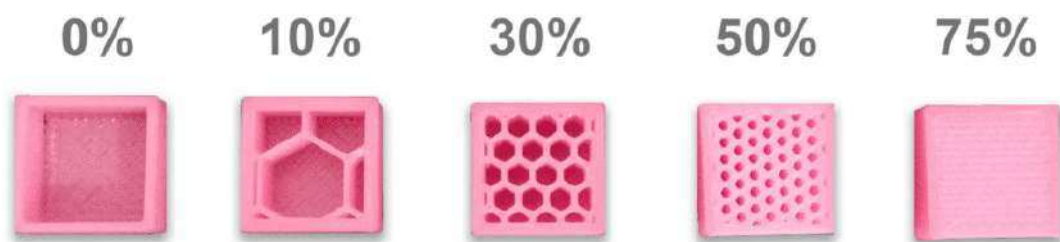
Figura 20 – Representação visual de diferentes densidades de preenchimento na impressão 3D
