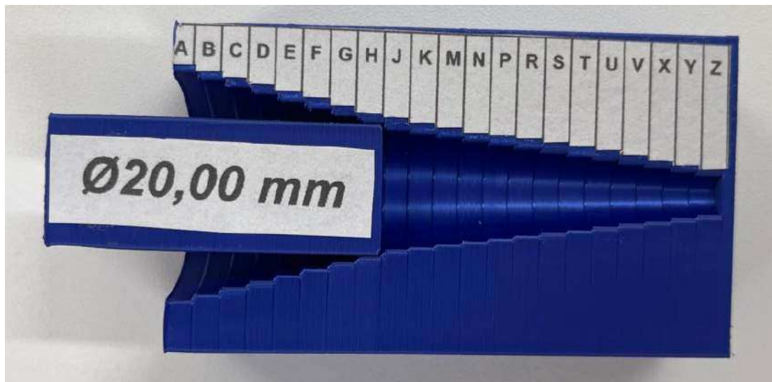
Figura 42 – Sistema de ajuste eixo-base impresso na impressora 3D e com as indicações coladas na peça.
