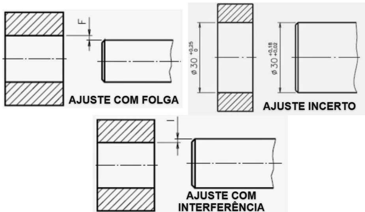
Figura 7 – Esquematização para ajuste com folga, ajuste incerto e ajuste com interferência
