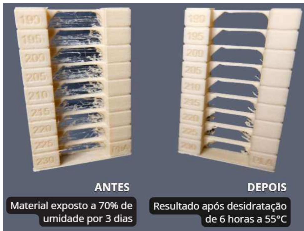
Figura 17 – Comparativo de qualidade de impressão entre filamento úmido e seco.
