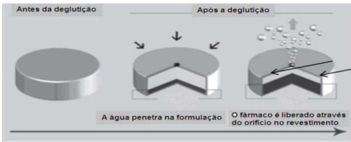
Figura 8 - Bomba osmótica “push-pull”.
