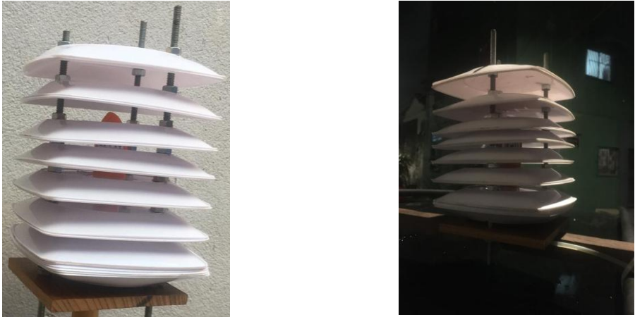
Figura 12. Abrigo meteorológico para o termohigrômetro.
