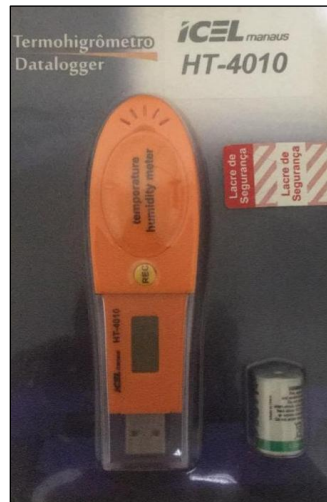
Figura 10. Termohigrômetro, tipo Datalogger, modelo HT-4010.
