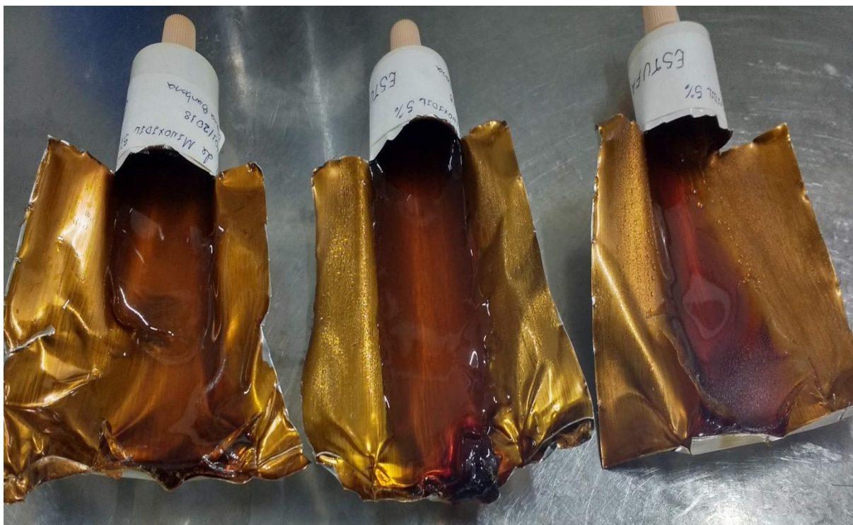
Figura 6 – Exposição do material contido nas bisnagas de alumínio acondicionadas em estufa no tempo T120
