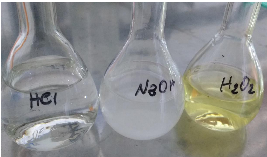
Figura 2 – Degradação do minoxidil em meio ácido, básico e oxidativo
