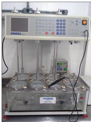
Figura 5 – Dissolutor modelo DT80 – Erweka
