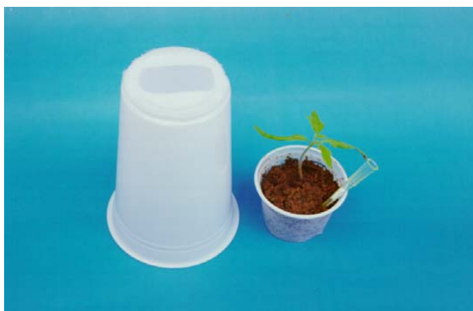
Figura 15- Muda inoculada, ponteira e gaiola confeccionada com copo plástico descartável de 300 ml.
