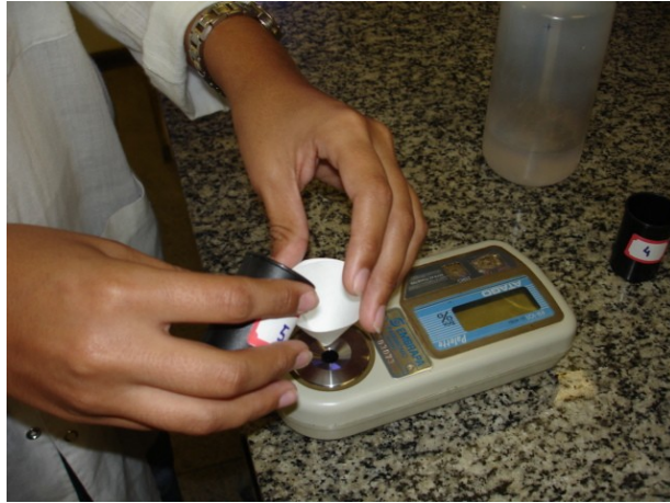
FIGURA 10 - Determinação dos sólidos solúveis totais (SST) através de refratômetro digital. Fortaleza – CE, 2005.
