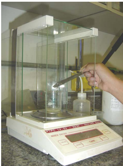
FIGURA 11 - Determinação da vitamina C através de titulometria com solução de DFI (2,6 dicloro-fenolindofenol 0,02%). Fortaleza – CE, 2005.
