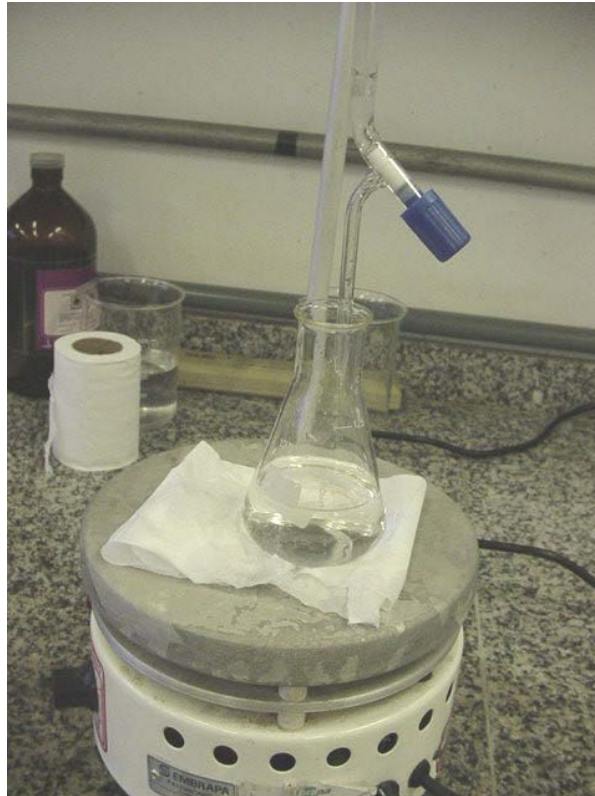
FIGURA 9 - Determinação da acidez total titulável (ATT) através de titulação com solução de NaOH. Fortaleza – CE, 2005.
