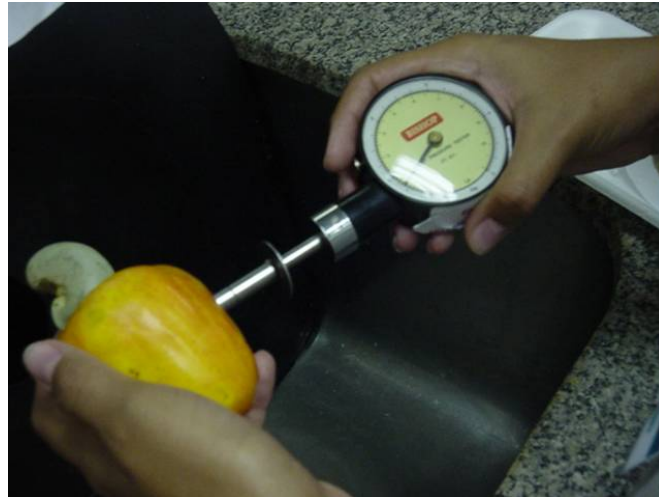
FIGURA 7 - Avaliação da firmeza da polpa através de penetrômetro manual. Fortaleza – CE, 2005.
