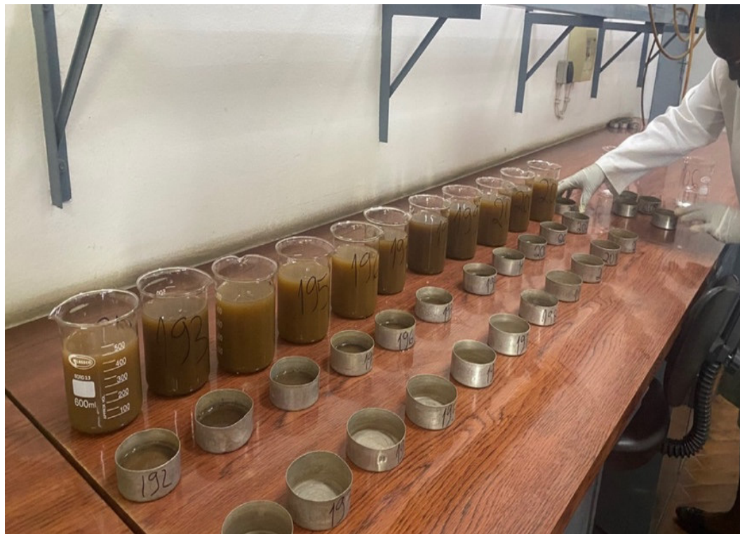
Figura 17 - Processo de análise laboratorial das amostras para a estimativa da textura.
