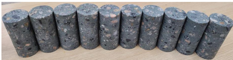
Figura 25 – Corpos de prova extraídos para execução dos ensaios de determinação do módulo e fadiga
