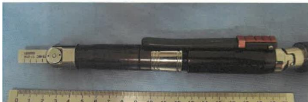
Figura 5 - Motor marca ITS a nitrogênio com serra
