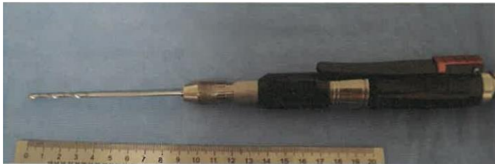
Figura 4 - Motor marca ITS a nitrogênio com broca helicoidal de 2mm
