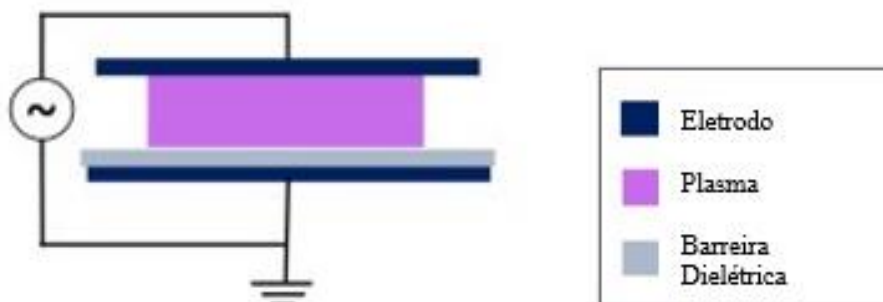
Figura 2 – Diagrama do dispositivo de plasma de descarga de barreira dielétrica.
