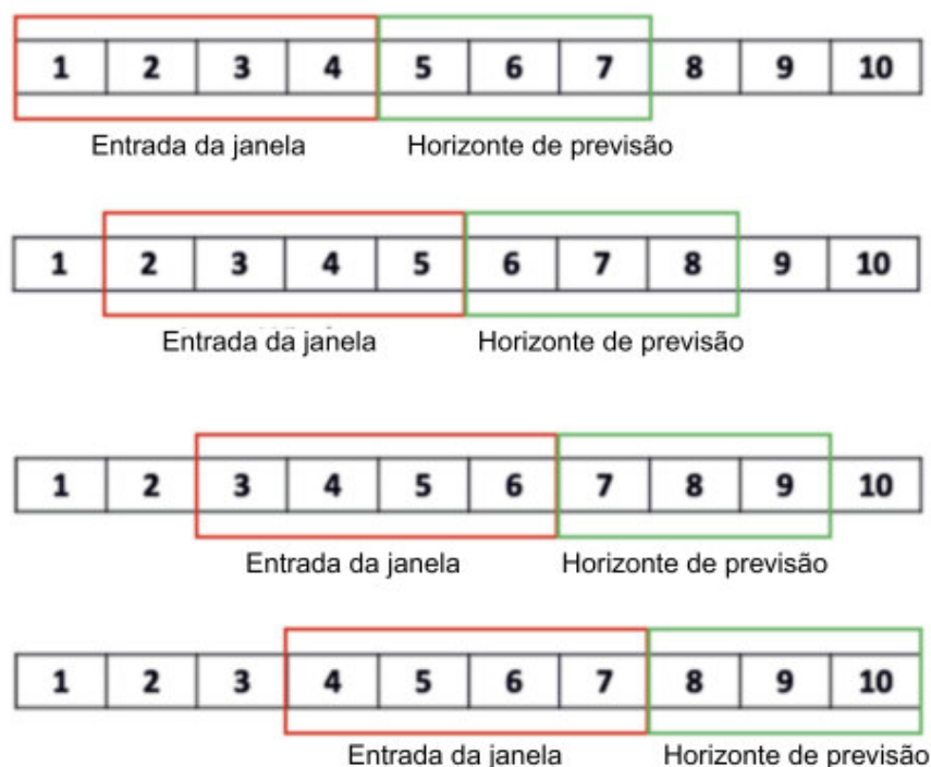
Figura 9. Representação esquemática de janelas deslizantes de tamanho 4 para um horizonte de previsão fixo de 3.
