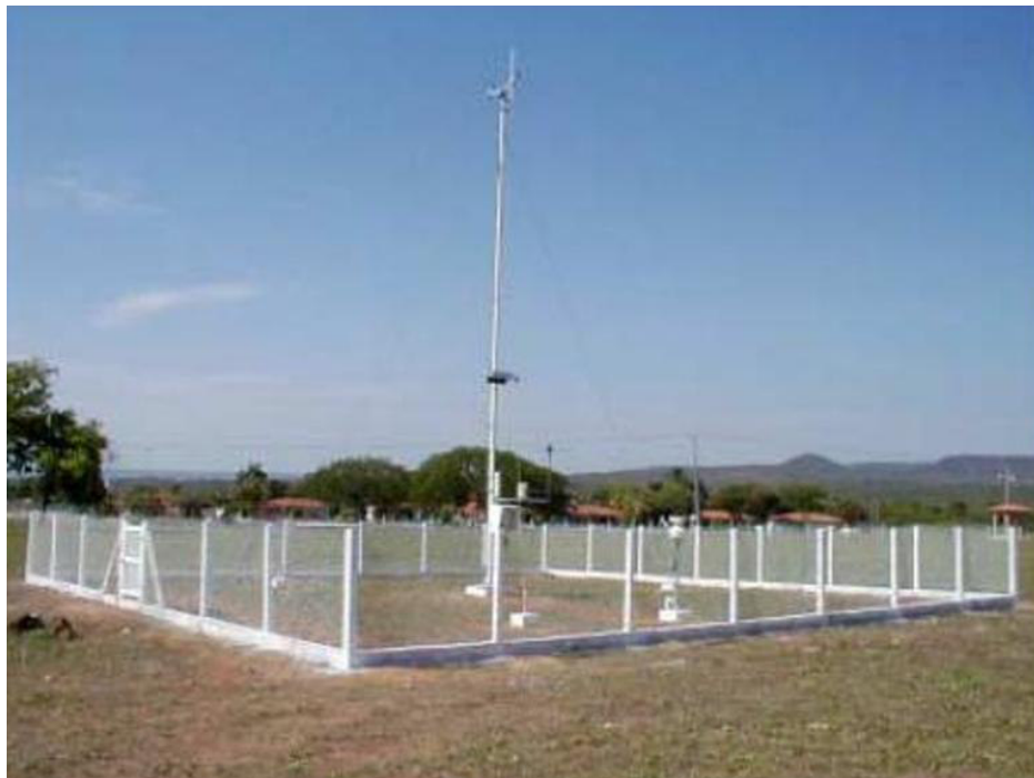
Figura 14. Estação Meteorológica Automática do INMET em funcionamento.
