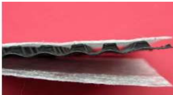
Figura 26 - Representação de um geocomposto de drenagem
