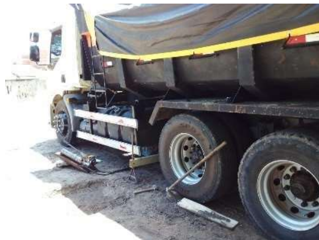
Figura 49: Caminhão utilizado como sistema de reação
