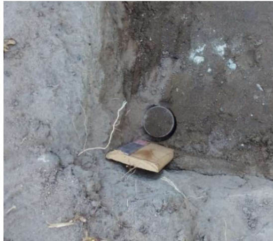
Figura 61 – cravação do cilindro
