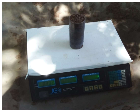
Figura 62 – pesagem do conjunto cilindro de cravação e solo
