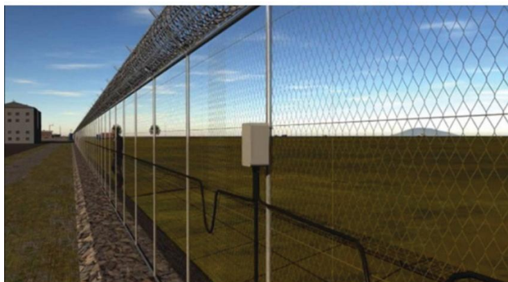
Figura 6 - Sistema de detecção por fibra óptica instalado ao longo de uma cerca perimetral
