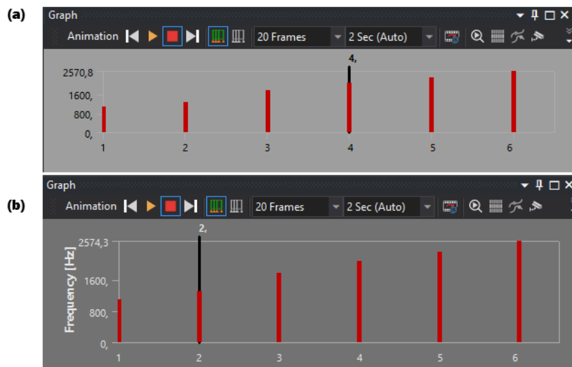
Gráfico 4 – Gráficos ANSYS das Frequências (a) antes da trinca (b) após a trinca
