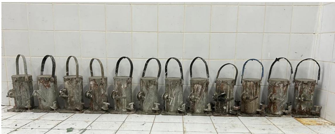
Figura 9 – Corpos de prova no molde logo após fabricação
