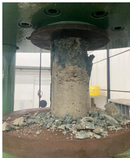
Figura 14 – Exemplo da falha de um corpo de prova durante o ensaio de compressão
