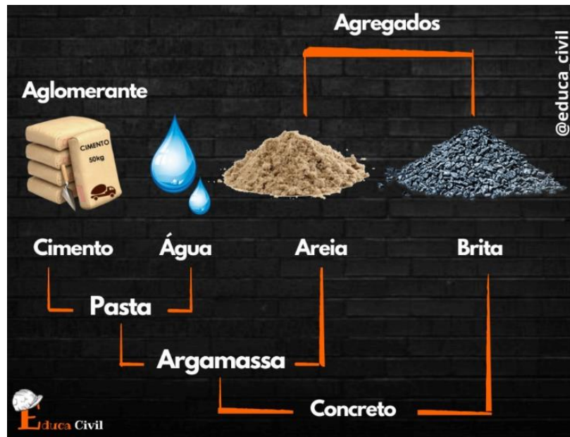
Figura 1 – Diferença entre pasta, argamassa e concreto em termos de seus constituintes
