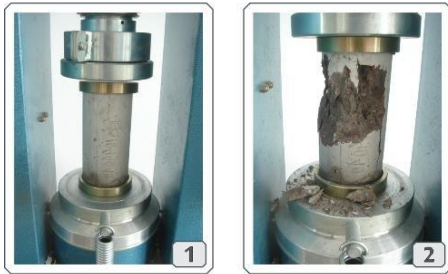
Figura 7 – Ensaio de resistência à compressão em prensa manual de 100 toneladas: (1) CP de concreto durante o rompimento e (2) CP rompido
