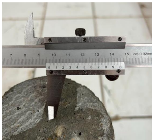
Figura 12 – Medições ortogonais nos corpos de prova
