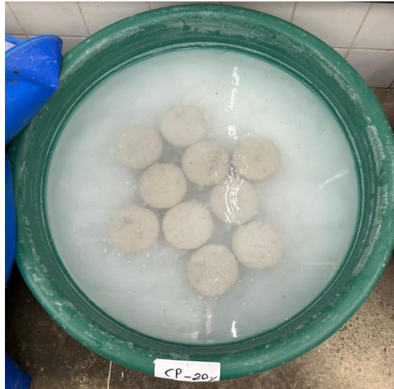
Figura 10 – Corpos de prova imersos no banho de água e cal
