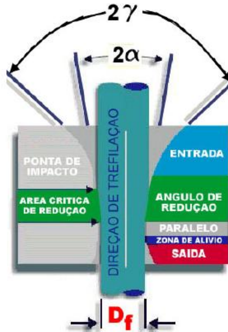
Figura 9 - Esquemático de uma fieira e seus parâmetros de controle durante a trefilação.
