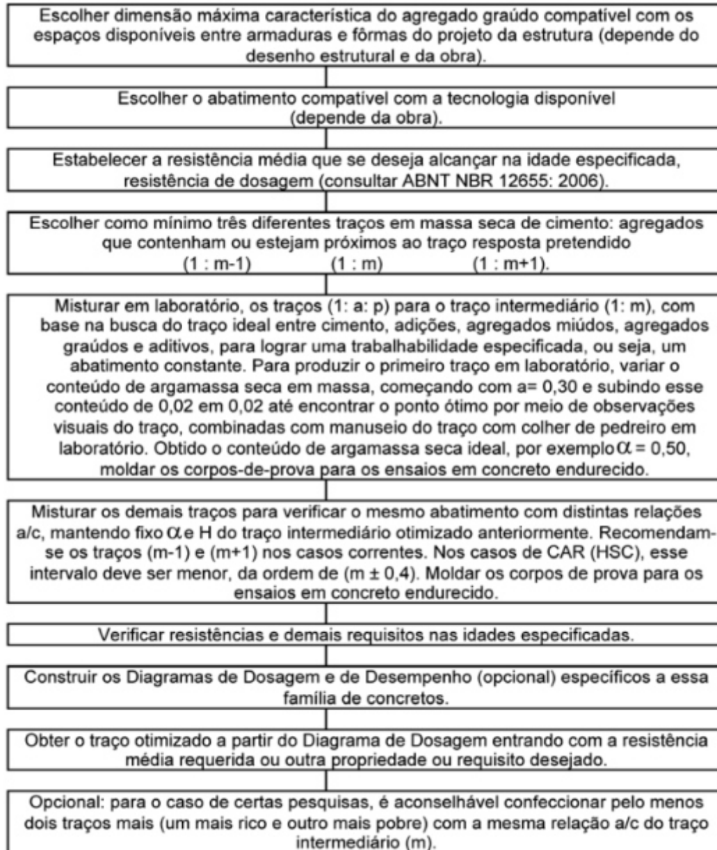
Figura 3 - Fluxograma do método de dosagem IBRACON.
