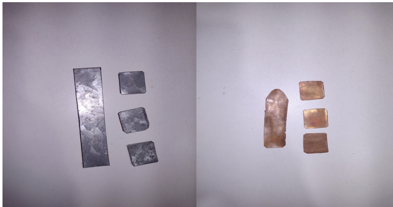
Figura 9 – Eletrodos de zinco e cobre confeccionados utilizados nos experimentos.
