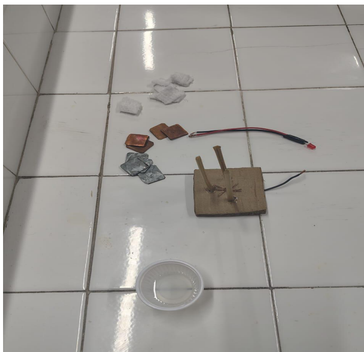
Figura 12 – Material completo para a construção da pilha voltaica.
