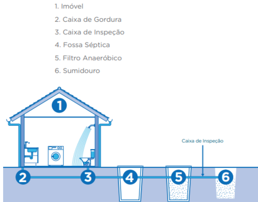
Figura 2 – Exemplo de solução individual para tratamento de esgoto doméstico
