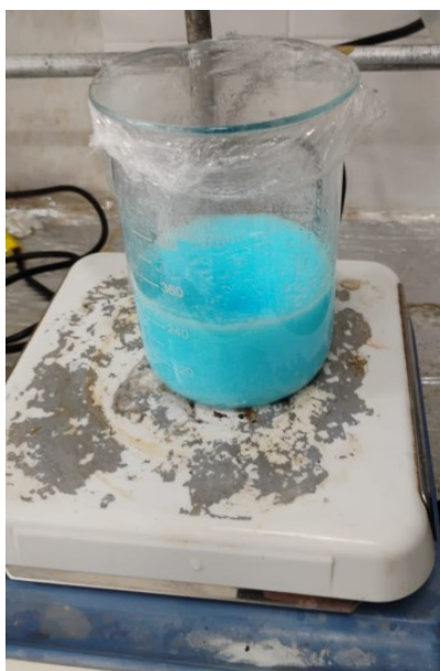
Figura 6 – Suspensão de HKUST-1 em água obtida no procedimento sintético de HKUST-1
