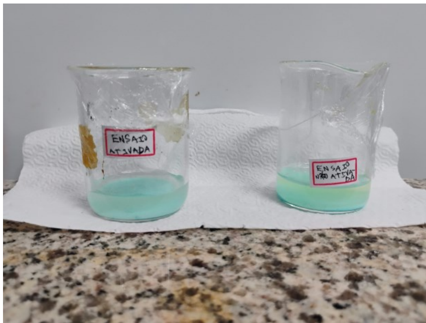
Figura 18 – Ensaio de adsorção de 4-nitrofenol em solução aquosa para a MOF HKUST-1 em pó ativada e não ativada
