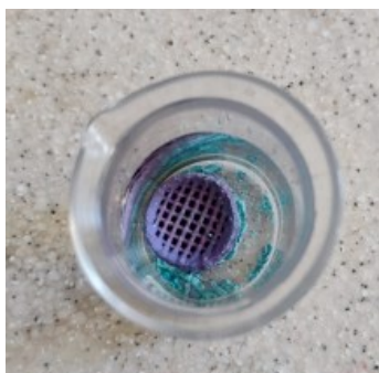
Figura 21 – Leito de HKUST-1 durante o ensaio de dessorção de safranina
