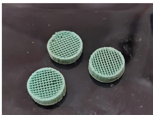
Figura 11 – Leitos de HKUST-1 manufacturados via impressão 3D, após aquecimento a 220 °C por 12 horas
