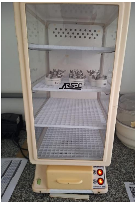
Figura 16 – Células de permeação para análise de PVA das amostras de polpa moldada
