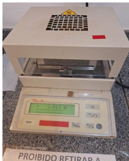
Figura 8 – Balança de infravermelho utilizada para análise de umidade
