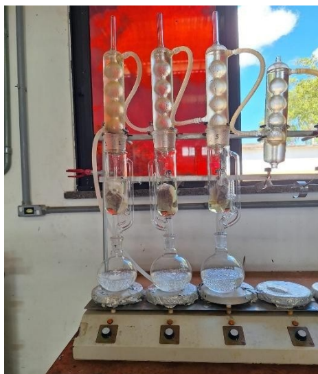
Figura 9 – Sistema de extração por Soxhlet
