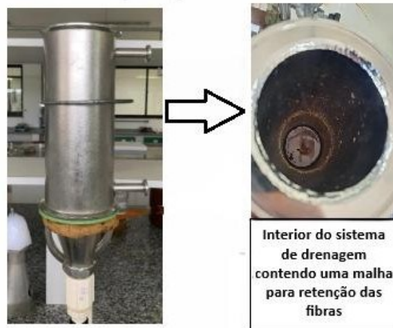
Figura 10 – Sistema de drenagem adaptado para a produção de polpa moldada
