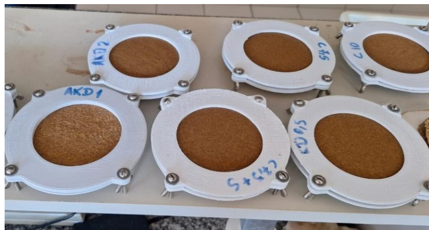
Figura 11 – Suporte de secagem das amostras de polpa moldada
