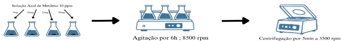
Figura 7. Esquema do teste de efeito da massa na adsorção em batelada.
