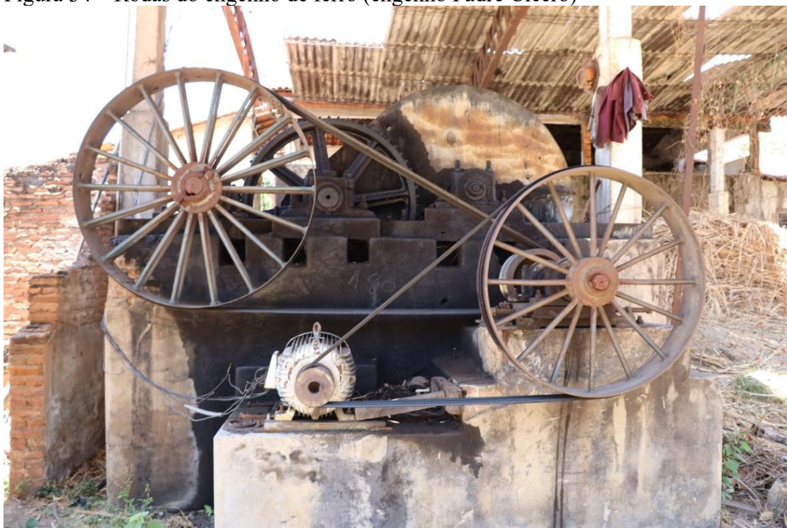
Figura 34 – Rodas do engenho de ferro (engenho Padre Cicero)
