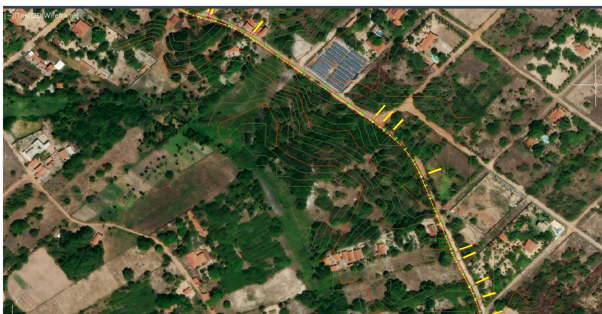
Figura 24 – Alinhamento e corredor lançado. Ao fundo, a verificação da locação com o recurso GEOMAP
