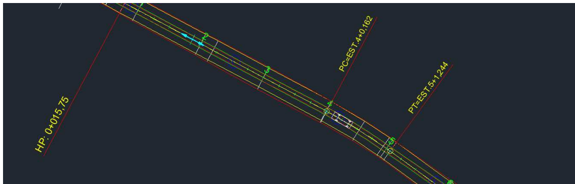
Figura 35 – Simulação em planta do veículo de projeto fazendo manobra em um trecho da via com curva horizontal
