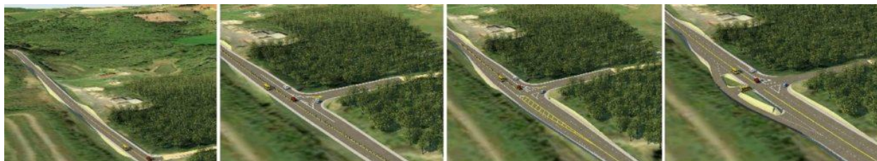
Figura 13 – Modelo de rodovia gerado por captura de drones e geoprocessamento
