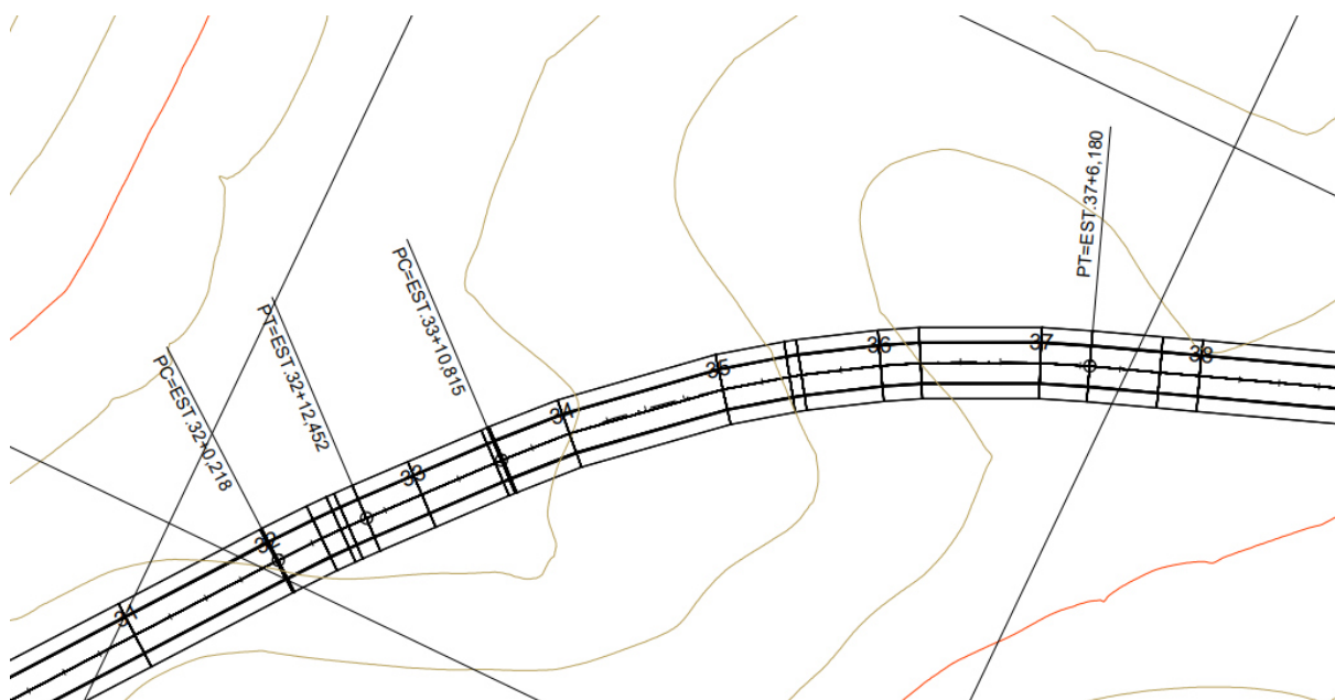
Figura 34 – Trecho do alinhamento horizontal com pontos notáveis seguidos
