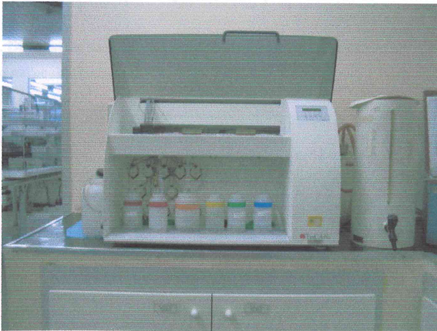
FIGURA-10. Aparelho semi-automático (ProfiBlot II N V.2.08) utilizado para realização do teste de Western Blot .
