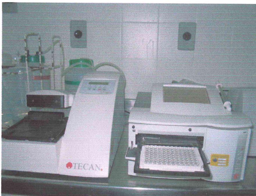
FIGURA-8. Lavadora e leitora automatizada utilizada para realização de testes de ELISA.
