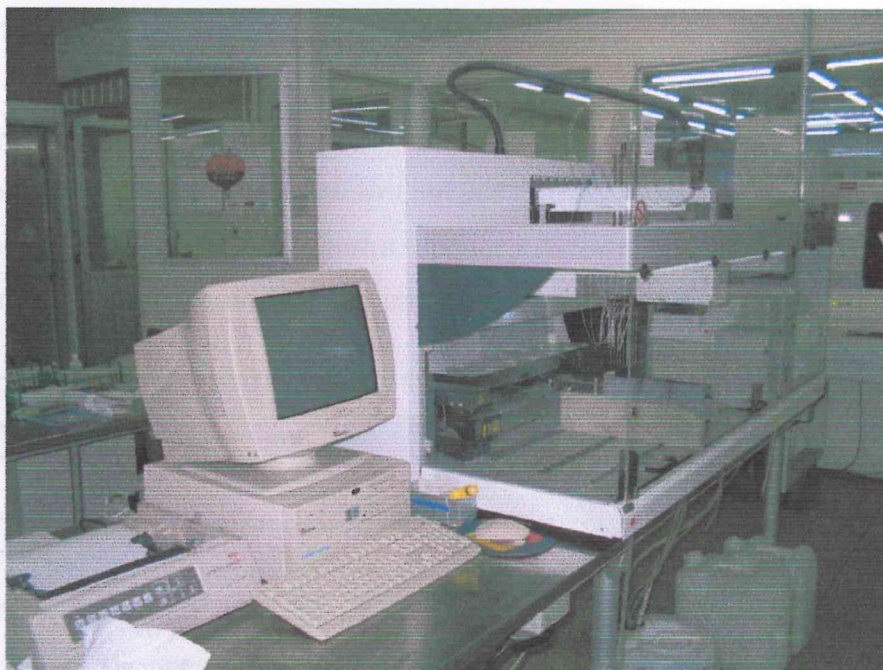
FIGURA-3. Aparelho automatizado (Gênesis RMP 150) usado para realização do teste de ELISA.
