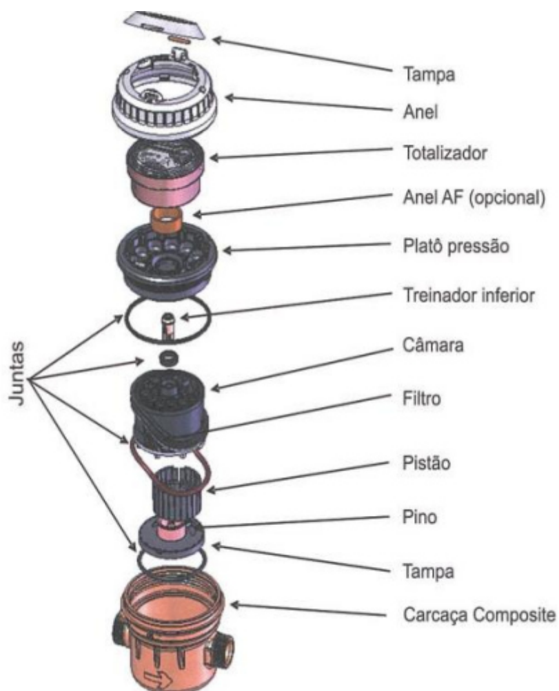
Figura 07: Hidrômetro Volumétrico, visão ampliada.
