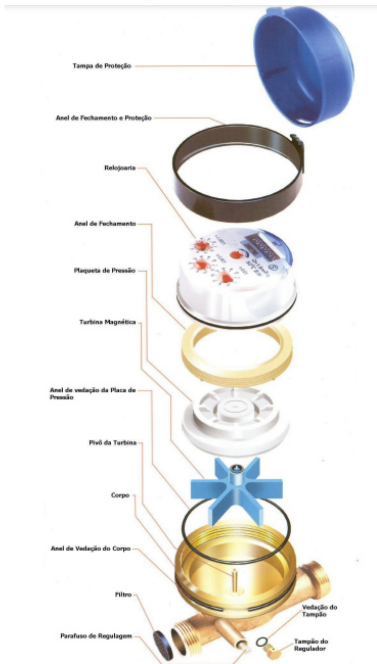
Figura 05: Hidrômetro Unijato, vista ampliada.
