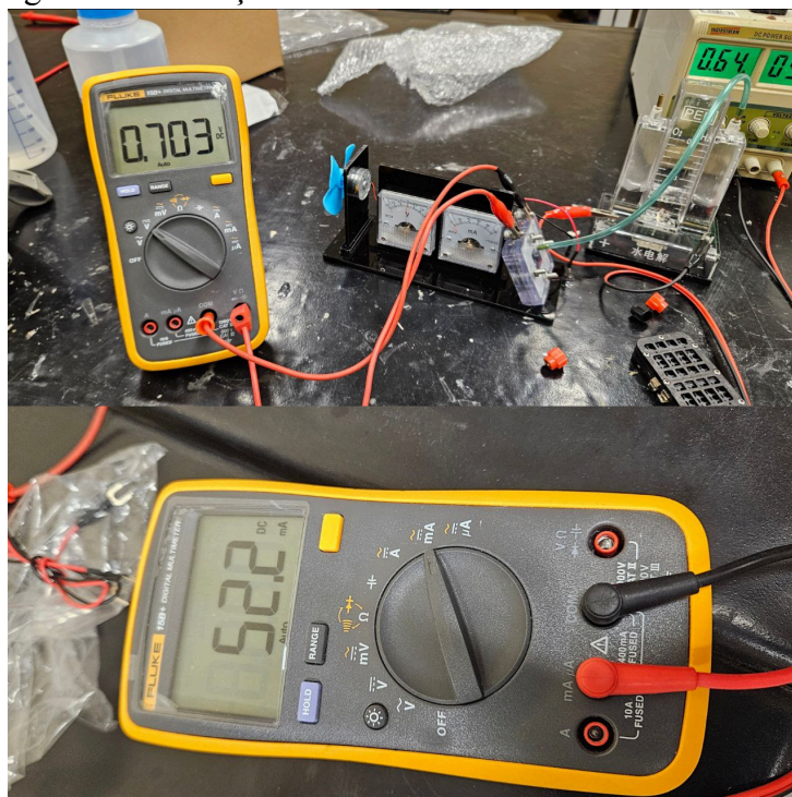
Figura 18 - Aferição de tensão e corrente da célula de teste
