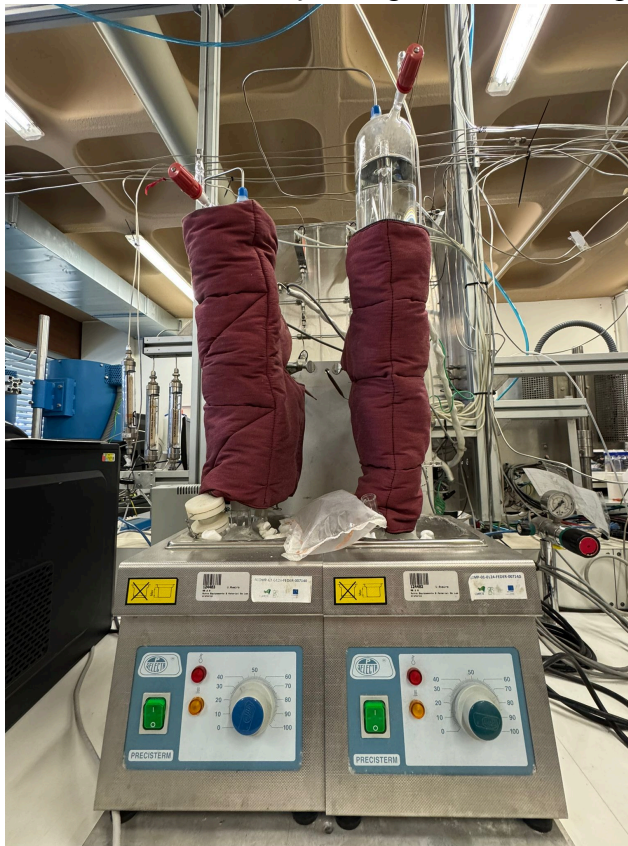
Figura 19 - Sistema de umidificação do gás encaminhado para o teste.
