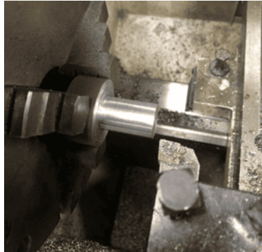
Figura 58 – a) Operação de desbaste em torno convencional no pino de correr b) Suportes cilíndrico e flanges inacabados
