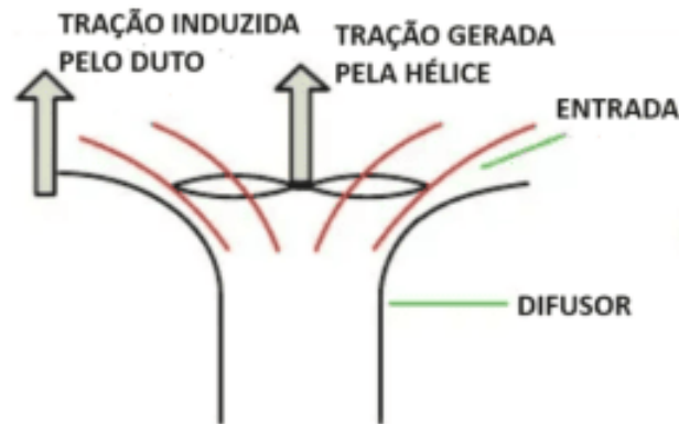
Figura 7 – Esquema de hélice em um duto
