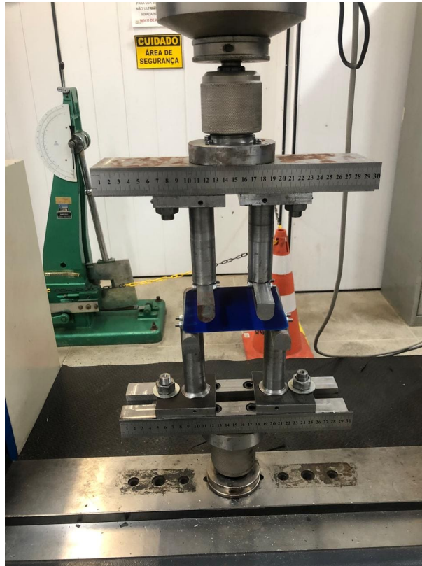
Figura 61 – Amostra posicionada para ensaio de flexão de 4 pontos.
