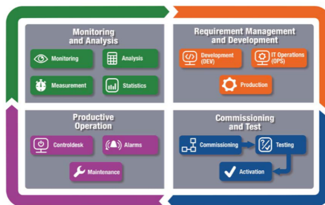
Figura 6 – Processo contínuo de adaptação e melhoria do DevOps industrial
