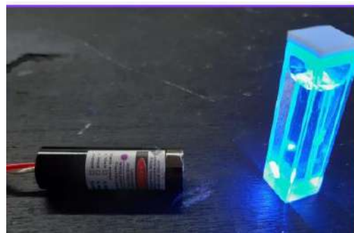
Figura 21 – Fluorescência de uma solução de cumarina excitada por um laser a 400 nm
