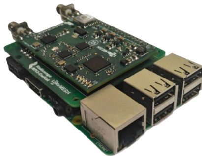
Figura 15 – Gateway LoRaWAN Radioenge
