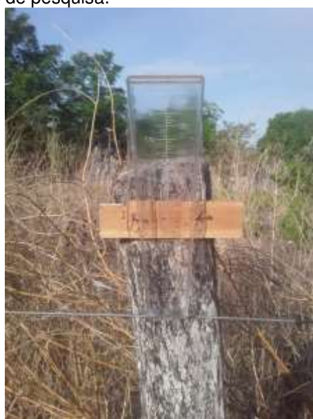
Figura 34 – Pluviômetro instalado na área de pesquisa.
