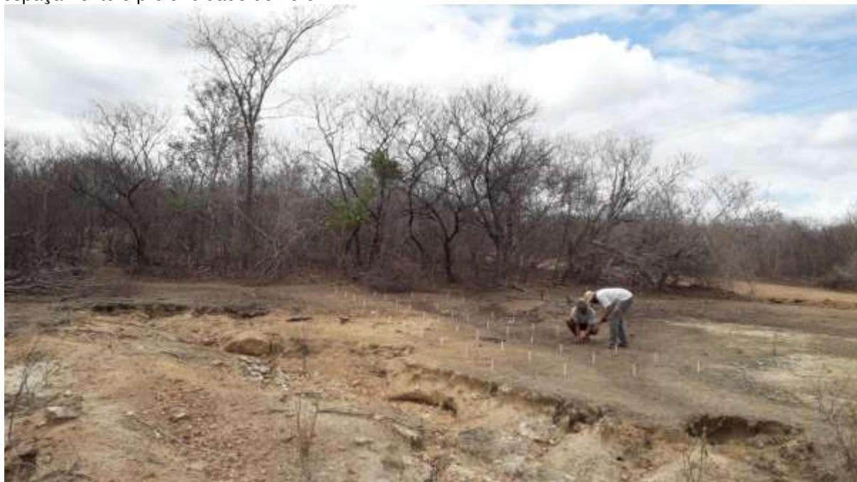
Figura 7 - Vista geral da Área Experimental III com os pinos de erosão instalados com detalhes de espaçamento e profundidade de 15 cm.
