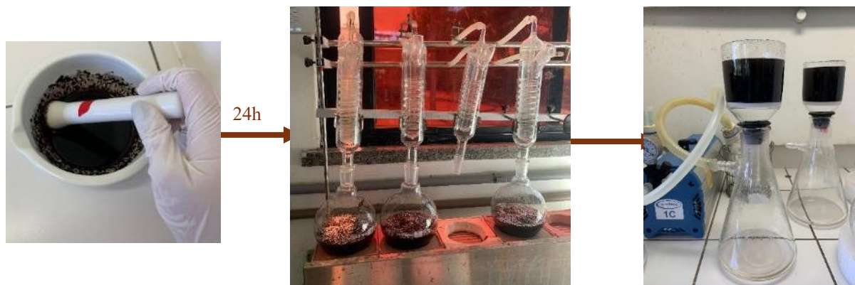
Figura 7 – Resumo do passo a passo para a realização da análise de determinação do teor de lignina insolúvel.
