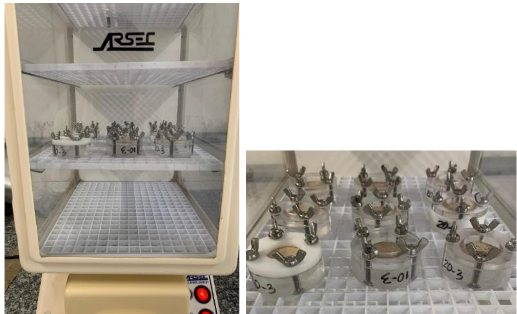
Figura 16 – Células de permeação para análise de PVA e dessecador vertical Arsec DCV040.
