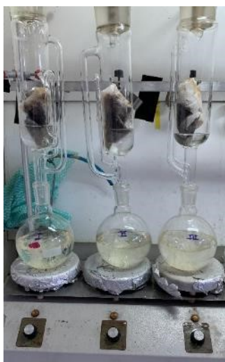
Figura 6 – Extração da madeira do cajueiro em triplicata, utilizando o Sistema Soxhlet.
