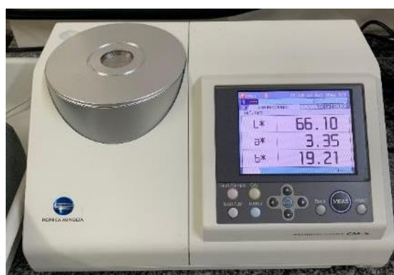
Figura 14 - Espectrofotômetro da marca Konica Minolta modelo CM – 5.
