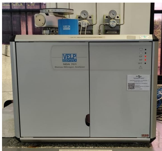
Figura 13 – Analisador de nitrogênio VELP NDA 701.
