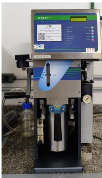
Figura 12 – Extrator de Gordura ANKOM XT15.
