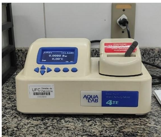
Figura 11 – Analisador de atividade de água (Aqua-lab 4TE).
